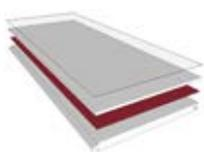
La qualità totale ci impone di utilizzare collanti vinilici D4 su tutta la gamma dei nostri prodotti. La delaminazione del legno dal supporto è una delle cause più importanti di difetti strutturali in un pavimento ingegnerizzato. Stile non fa compromessi o distinzioni tra formati e specie legnose. Tutto al massimo!
